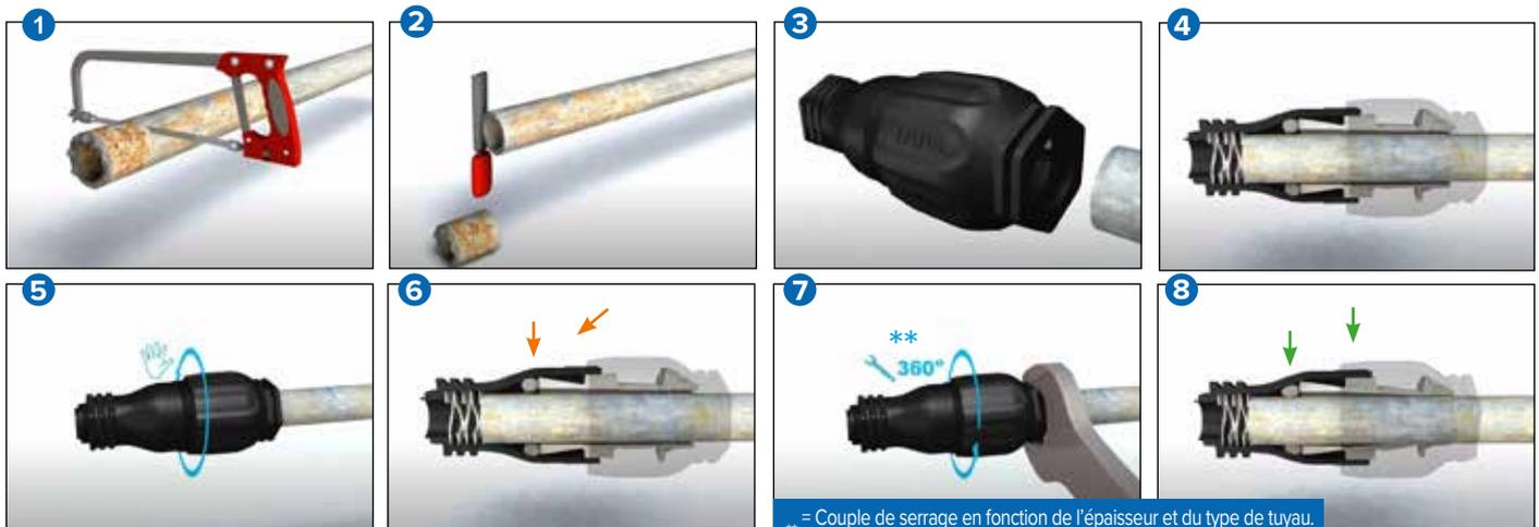
1. Couper ou scier le tube à la longueur souhaitée - 2. Ébavurer et chanfreiner légèrement le tube - 3.+ 4. Glisser le raccord sur le tube jusqu'en butée - 5.+ 6. Monter le raccord à la main - 7
